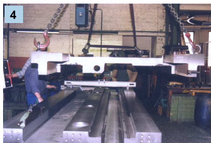
Установка ползуна на станину
